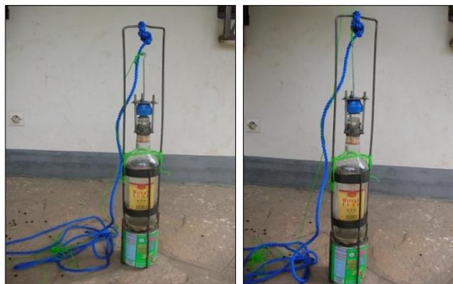
Photo 3A (de gauche) et 3B (de droite) : Bouteille de prélèvement d'eau dans les cours d'eau. 2A : bouchon fermé, 2B : bouchon ouvert (clichés KANKPENANDJA)
